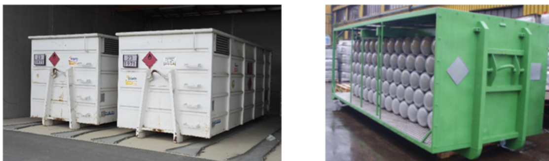
Abbildung 9: Vorrichtungen zum mobilen Transport von Biogas bzw. Biomethan
